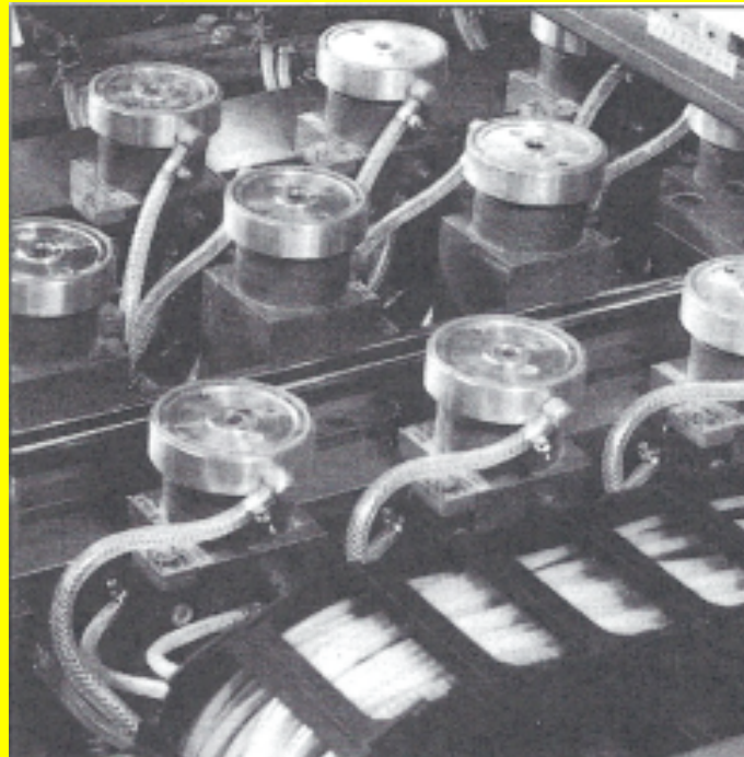
Obr. 4 Upínání obrobku vakuovými přísavkami
