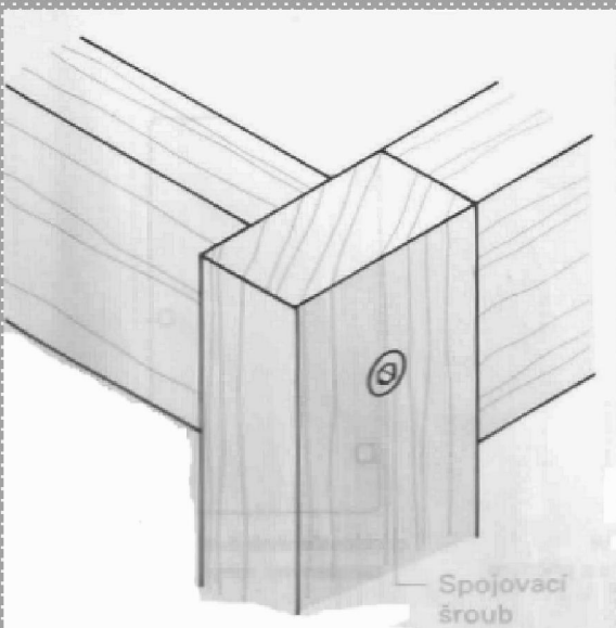
Spojení podnoží šroubem s příčnou válečkovou maticí
