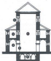
Řez bazilikou: 1) hlavní loď s plochým stropem; 2) sdružená okna; 3) empora (tribuna); 4) boční klenutá loď; 5) pilíře; 6) krypta
