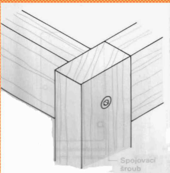
Spojení podnoží šroubem s příčnou válečkovou maticí
