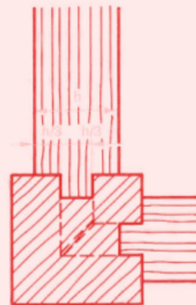
Spojení podnoží na čep a dlab s perem
