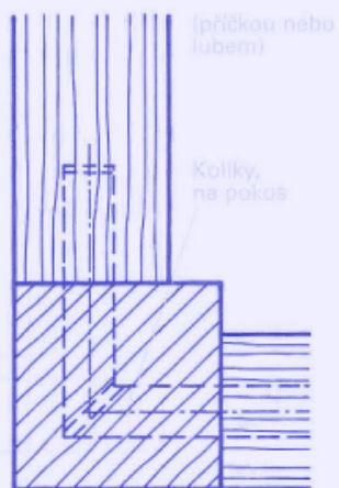
Spojení podstavce (podnoží) na kolíky
