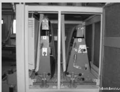
C 2 - dvoupásová horní bruska s přitlačnou patkou, spodní se stykovou pásovnící
