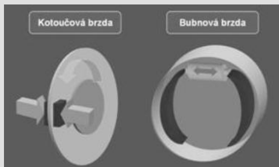
Obr. 1: Kotoučová brzda s pevným třmenem
