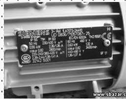
Identifikační štítek trojfázového motoru
