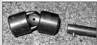
Kloubová křížová spojka a vyrovnávací kolíková spojka
