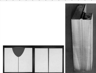
Obr. 11 Úzká svarů (vlevo kovech, vpravo elektronovým paprskem)
