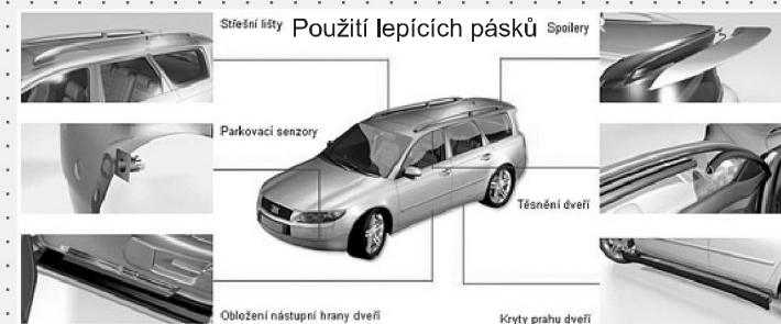
Příklad umístění epoxidových lepidel na karoserii automobilu
