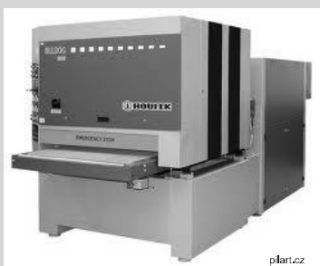
C 2 - dvoupásová horní bruska s přitlačnou patkou, spodní se stykovou pásovnící
