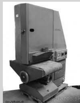
C 2 - dvoupásová horní bruska s přitlačnou patkou, spodní se stykovou pásovnící
