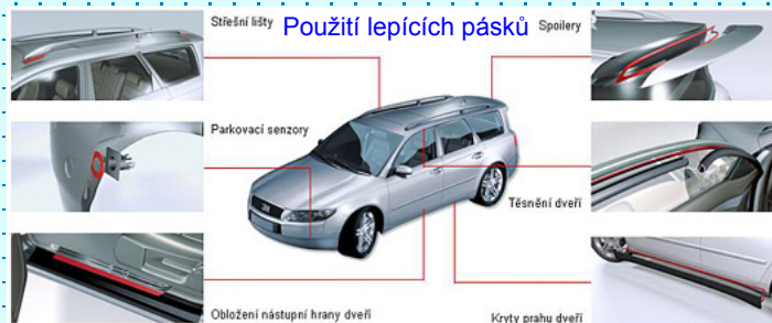
Příklad umístění epoxidových lepidel na karoserii automobilu
