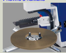
navádění hranovacího materiálu v návín a náklížku
