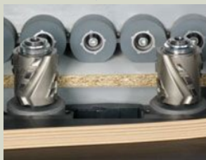
navádění hranovacího materiálu v návín a náklížku
