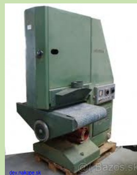
C 2 - dvoupásová horní bruska s přítlačnou patkou, spodní se stykovou pásovnící
