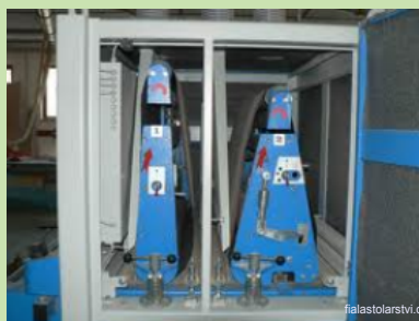
C 2 - dvoupásová horní bruska s přítlačnou patkou, spodní se stykovou pásovnící
