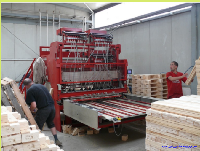
hřebíkový stůl pro spojování krabic
