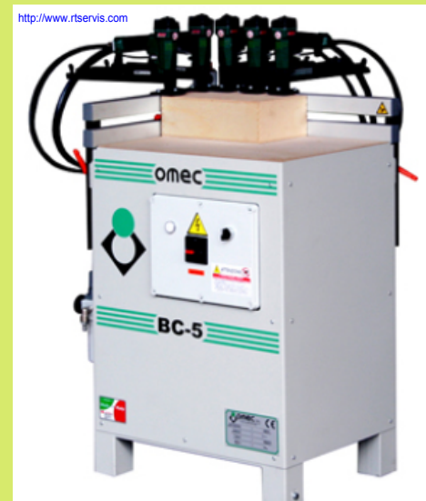
hřebíkový stůl pro spojování krabic
