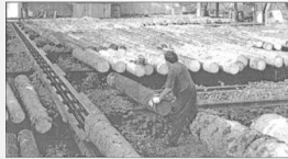
Obr. 11. Nakládání výřezů na dopravník do pilnice
