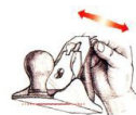
Pohybem páky doleva nebo doprava nastavíte ostří želízka rovnoběžně s hranou výřezu.
