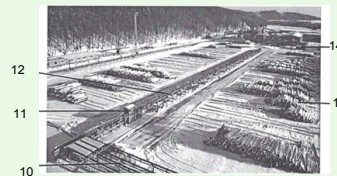
Obr. 14. Manipulačně-třídící linka kalutiny - třídící část 10 - příčný řetězový dopravník ke třídění, 11 - hledací kov, 12 - třídící výřezů, 13 - skládka výřezů, 14 - vstup do pilnice
