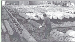
Obr. 11. Nakulování výřezů na dopravník do pilnice
