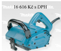
Kartáčová bruska Makita 9741 # K opracování dřeva, odstraňování rzi, barev apod., el. brzda, kartáč z plastu, zvl. příslušenství: kartáče pro různé materiály # 860 W, počet otáček 3.500 ot./min., rozměry kartáče: pr. 70-100 mm, šířka záběru 120 mm, hmotnost 4,2 kg.
